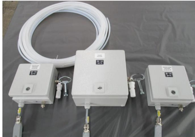
Die Drucksensoren werden elektronisch mit der Stützluftanlage verbunden. Dieses hat den Vorteil von deutlich längeren Leitungslängen. Hierdurch wird die Kondensatbildung gegenüber luftführenden Steuerleitungen minimiert.
