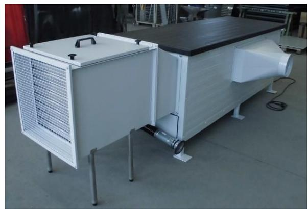
Verschmutzung aus der Luft kann Einbauteile der Luftversorgungssysteme beschädigen und zu Trübung und Verunreinigung in den Kissen führen. Standardmäßig sind unsere Geräte mit Filtern ausgestattet. In bestimmten Ländern reicht der Filter nicht aus, dort kommen komplette Filteranlagen zum Einsatz, diese Filteranlagen bestehen aus verschiedenen Filterstufen und sind auf die Einsatzbedingungen des jeweiligen Landes abgestimmt.
